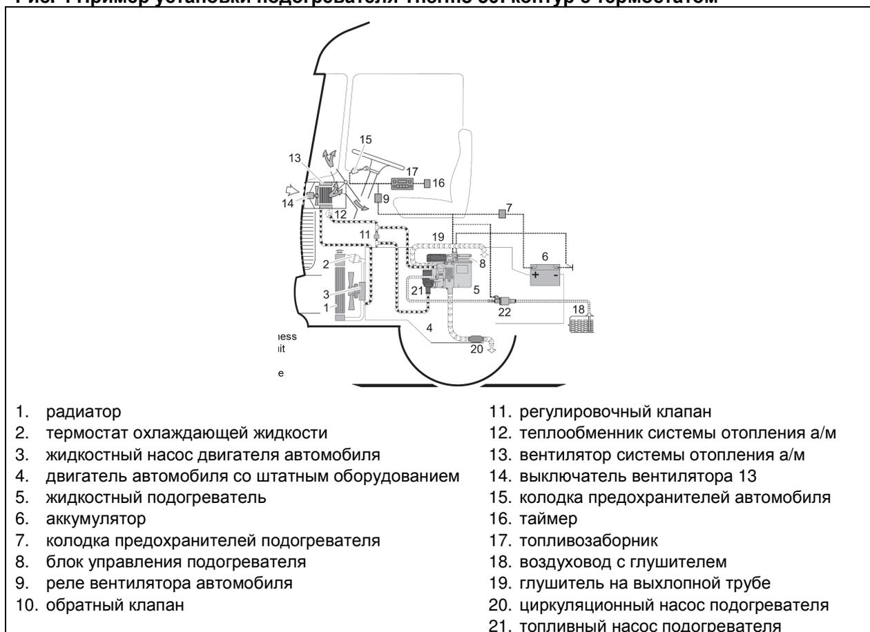
**Рис. 5 Пример установки подогревателя Thermo 50: контур без термостата**
